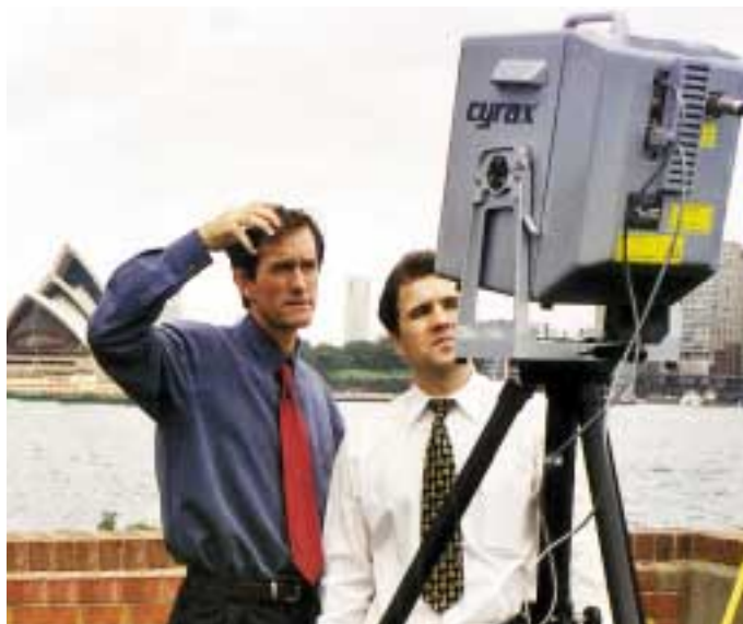
Die Vermessungstechnologie vollzieht Quantensprünge. Der CyraX 2500 kann komplexe Strukturen in sehr kurzer Zeit erfassen, wie ein Test an der Hafnbrücke Sydneys beweist. Er liefert genaue 3D-Modelle des Objektes, welches aus jeder Perspektive betrachtet werden kann.
